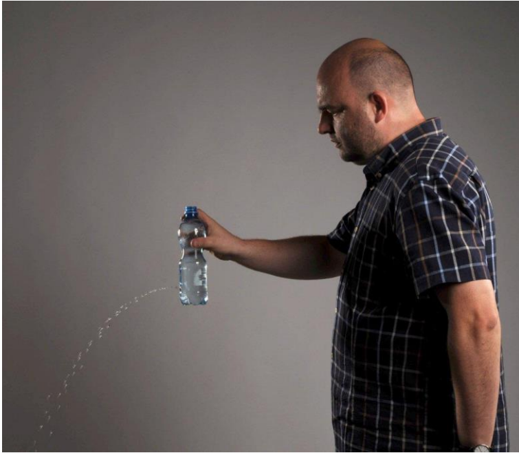
Rysunek 2. Woda wylatująca dzięki ciśnieniu hydrostatycznemu
