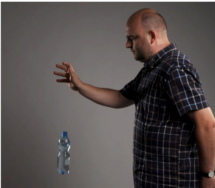
Rysunek 3. Brak ciśnienia hydrostatycznego w spadającej butelce
